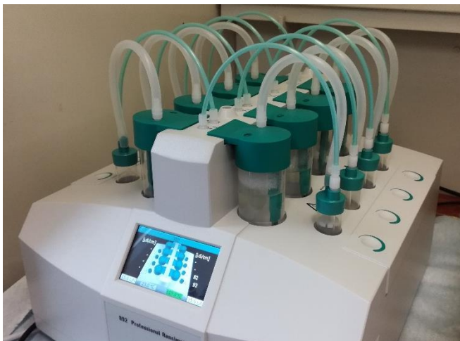
Slika 12: Delovanje naprave Rancimat (Vir: osebni arhiv)
